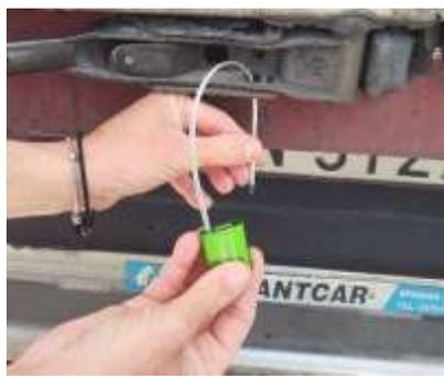
Insérez le fil dans le trou de la tête du scellé et tirez le plus loin possible. De cette façon, il n'y a pas de place pour l'altération.
