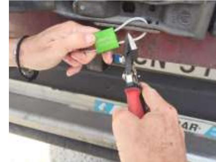
Pour retirer le scellé, il doit être coupé avec une pince spéciale.
